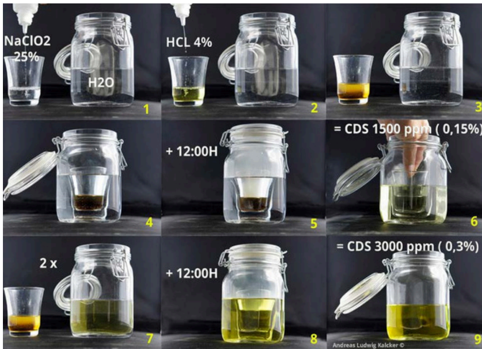
Fig. 50: Preparación de CDS con ácido clorhídrico como ativador.
